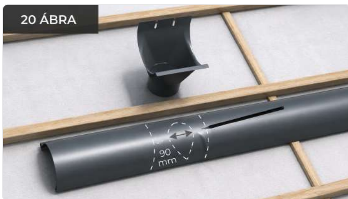
A betorkolócsonk helyének bejelölése a csatornán (90 mm).
