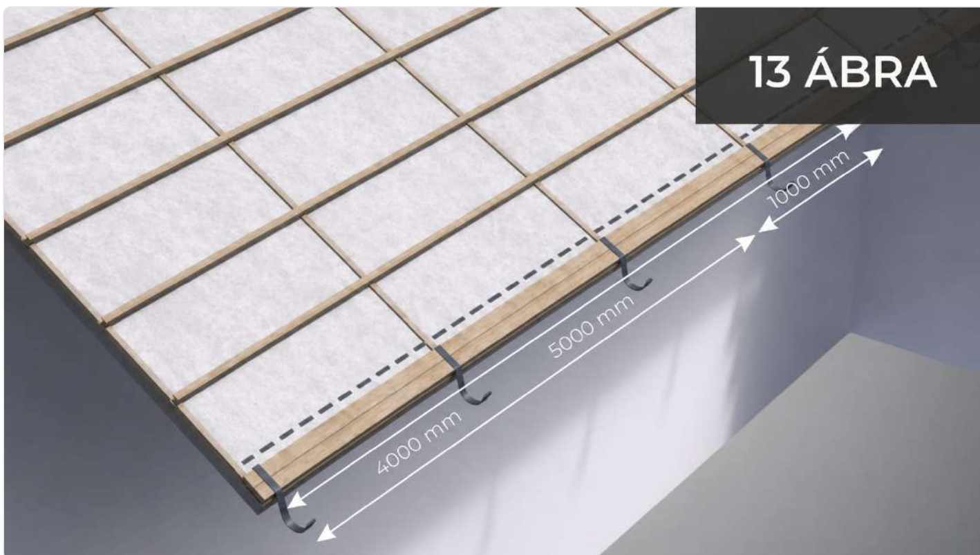
A felszerelt tartósor a tetőn. A tartók közötti távolság (D) = 600–900 mm; a méretek a bejelölt lejtésnek megfelelően.
