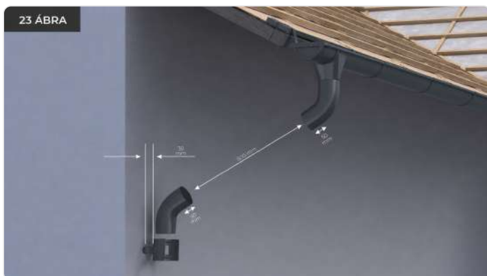
A 60°-os könyök és közdarab méretezése – 30 mm a faltól, az illesztési részek 50–50 mm.
