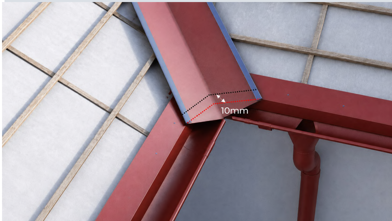
FIG.4 - Vápalemez felszerelése, 10 mm-es ráhajtással
